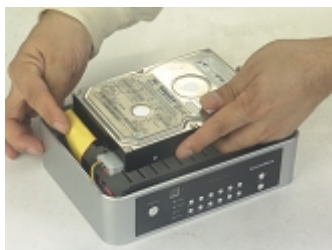
5. Collegare i cavi IDE e di alimentazione
