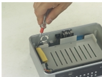
3. Svitare il supporto per HDD
