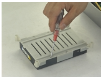
4. Avvitare l'HDD al supporto
