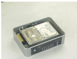
6. Inserire l'HDD nel case
